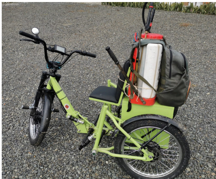
Prototipo mecanizado (V_6) de EL Triciparce trasladando fumigadora.
